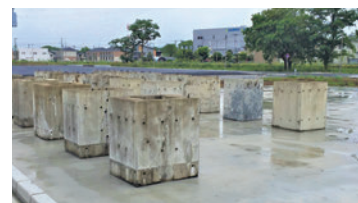
自己治癒コンクリートの暴露試験 Exposure test of developed self-healing concrete
