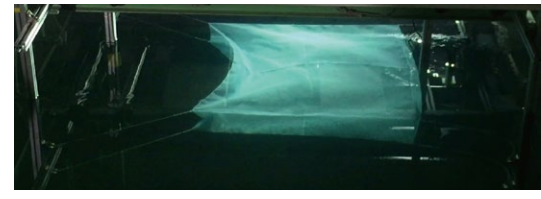
風路付き造波回流水槽における生簀網の抵抗試験 Drag test of cage netting at circulating water channel
