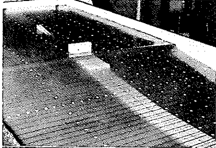
⇨ 沈埋トンネルの模型 (地盤：ゼラチン、トンネル：シリコンゴム)の振動実験の例で、地盤の挙動がトンネルの挙動を支配していることがわかる —田村研究室—
