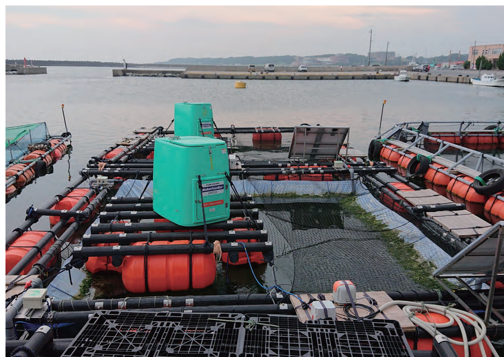
海面半閉鎖循環式養殖システム
