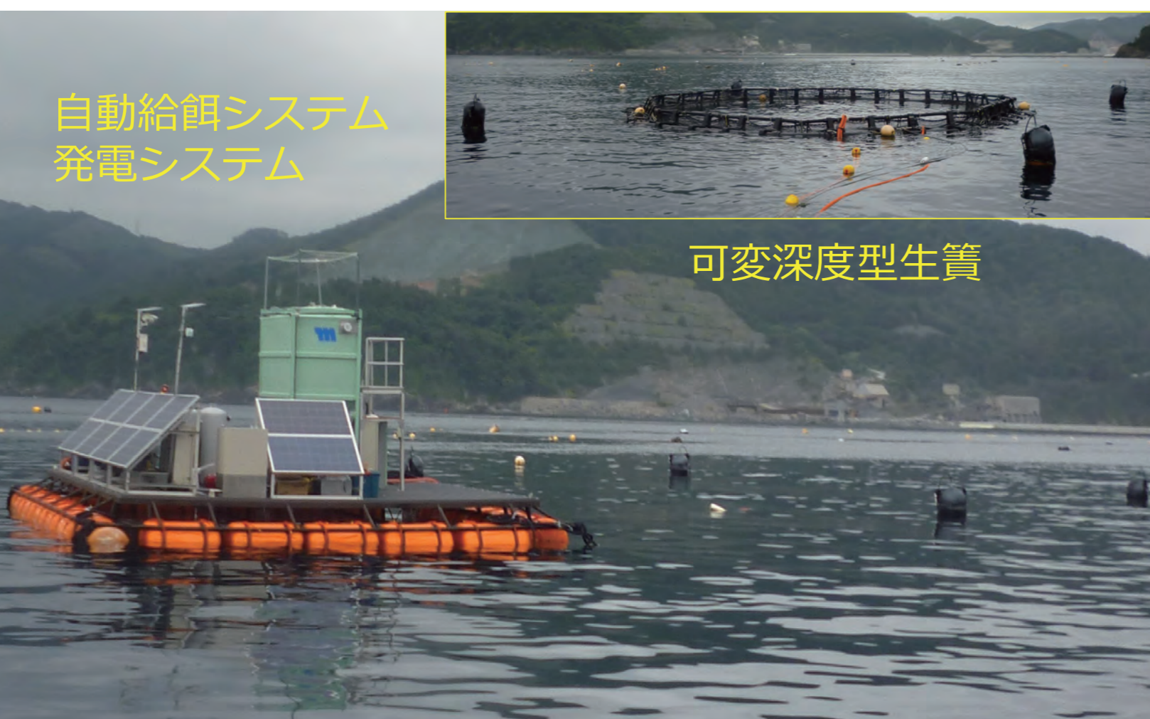
可変深度型生簀と自動給餌システム
