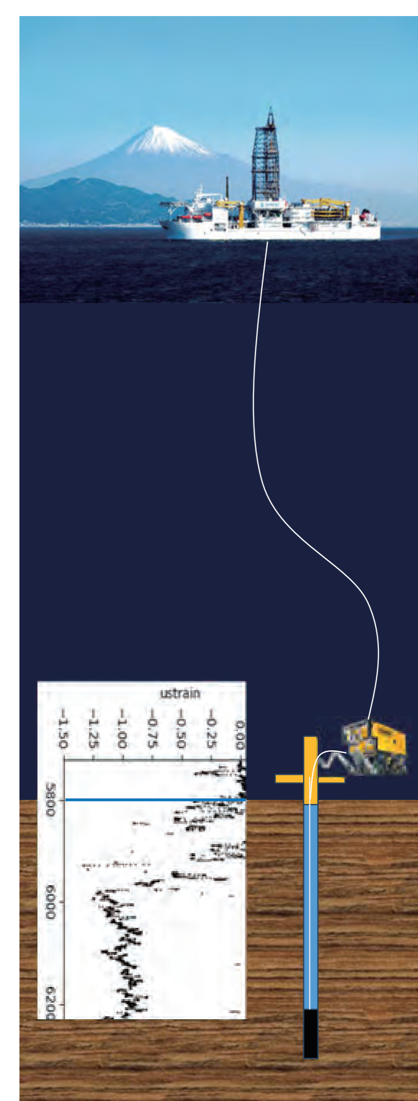
開発した光ファイバ歪観測装置(RFAS)
