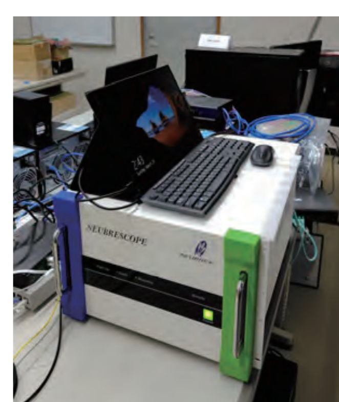
開発した光ファイバ歪観測装置(RFAS)
