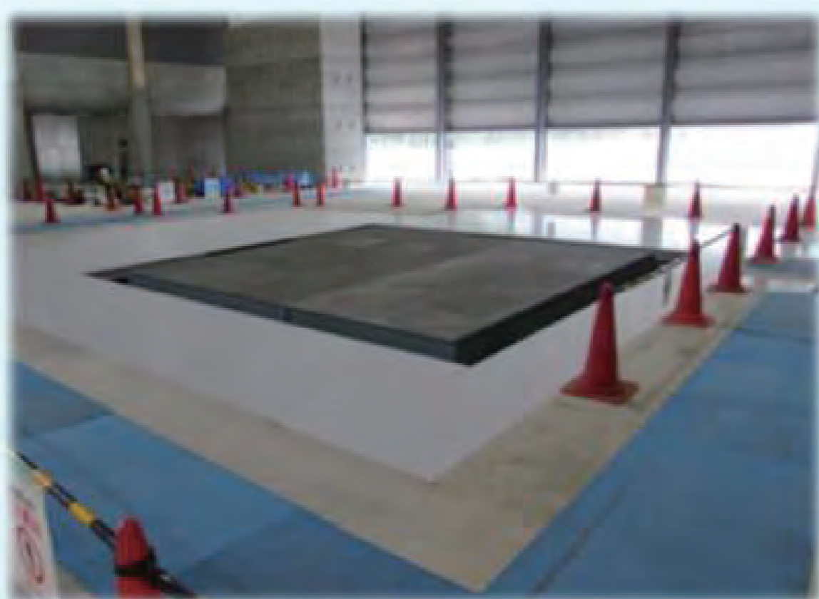
水平2次元振動台
