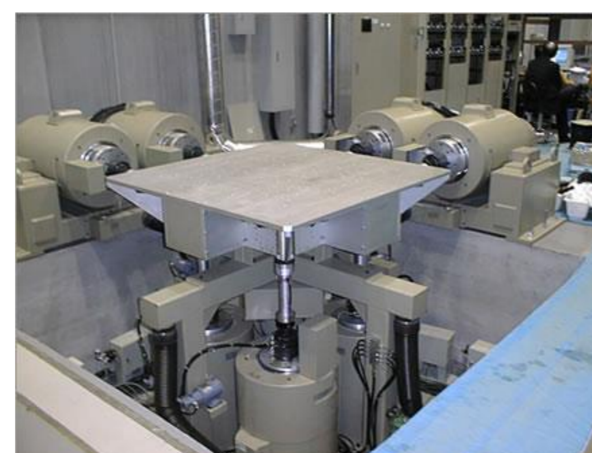
3-Axes 6-DoF Shaking Table (Komaba II)
