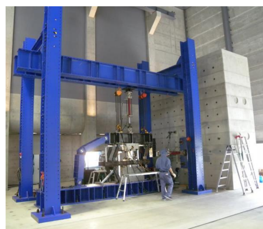
Static Loading Machine (Kashiwa I)
