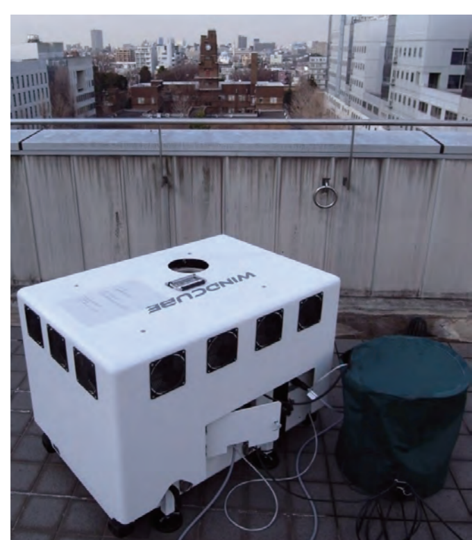
■ ドップラーライダーを用いた風速実測 ■ シンチロメータを用いた都市域の顕熱フラックス実測
