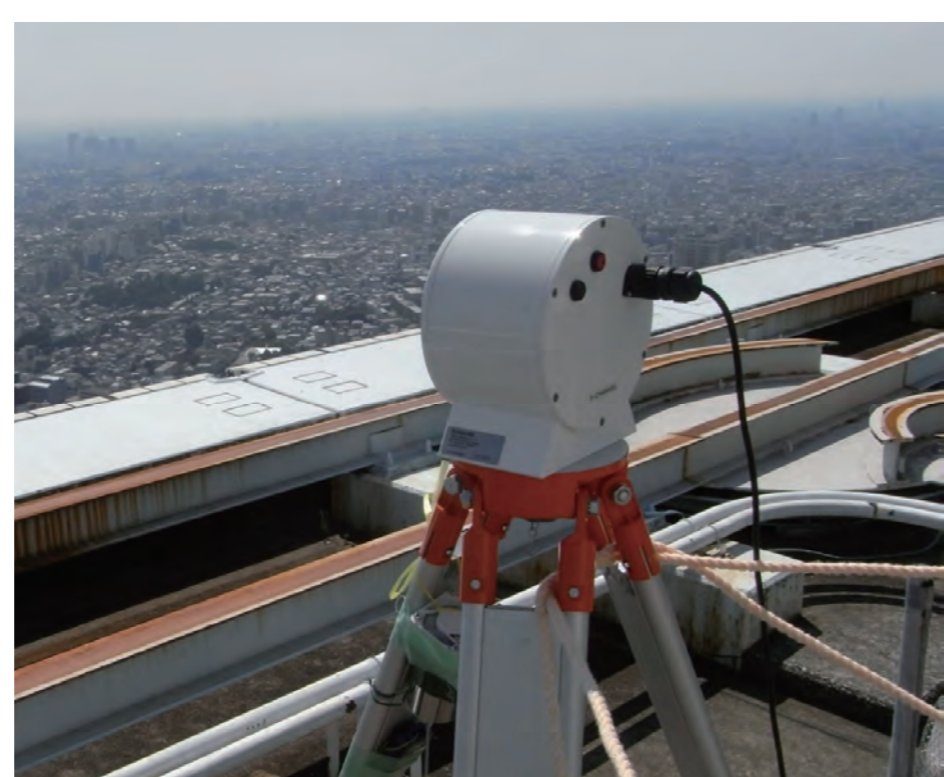
■ ドップラーライダーを用いた風速実測 ■ シンチロメータを用いた都市域の顕熱フラックス実測
