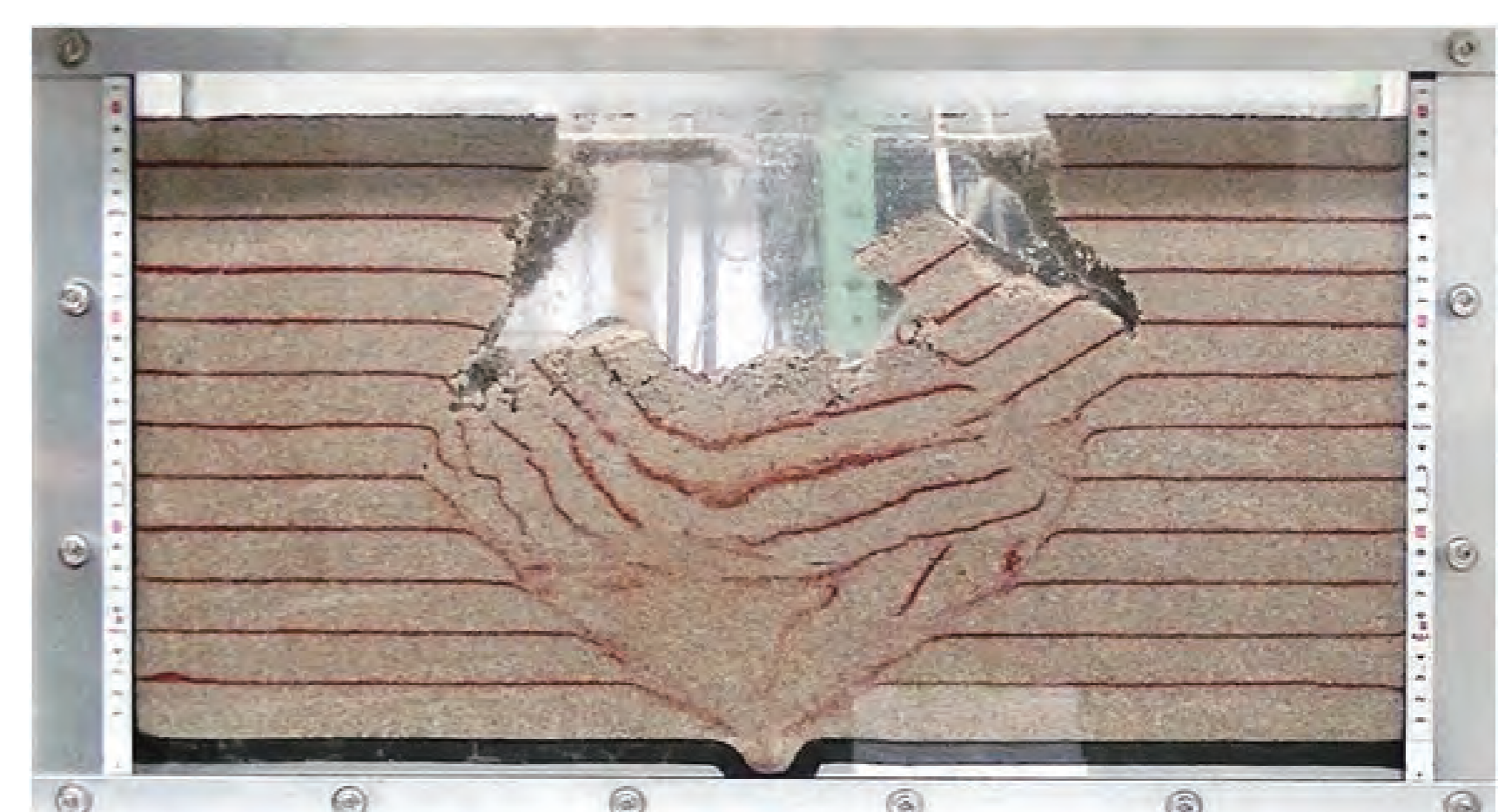
室内模型実験による、土砂流出、空洞生成・拡大、陥没メカニズムの再現
