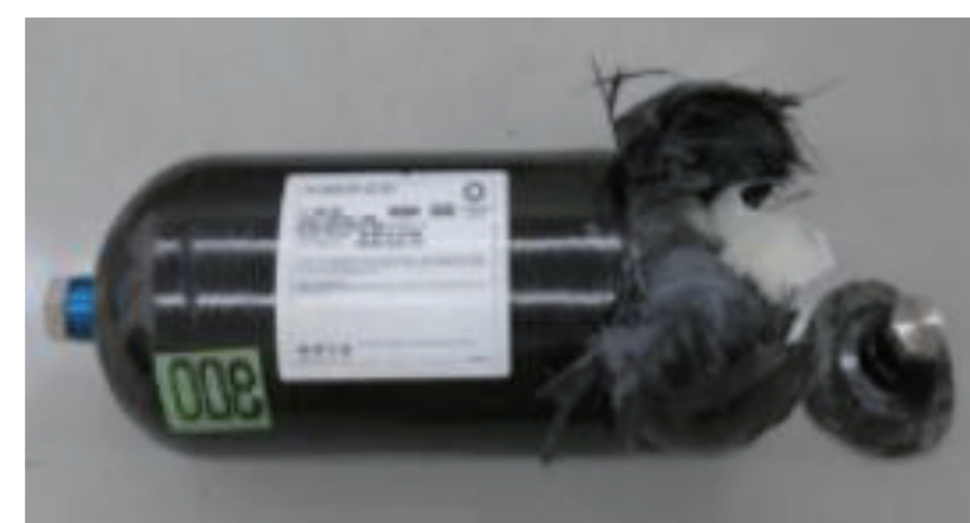
容器破裂試験による シミュレーションの検証
