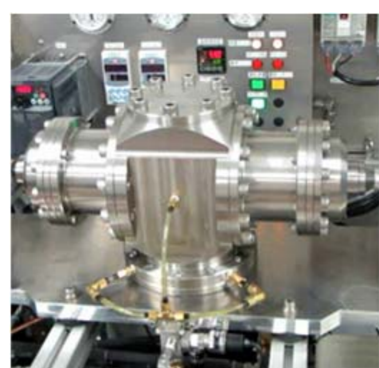
無振動なクロスバランス機構を採用した気液二相レシプロ膨張機
