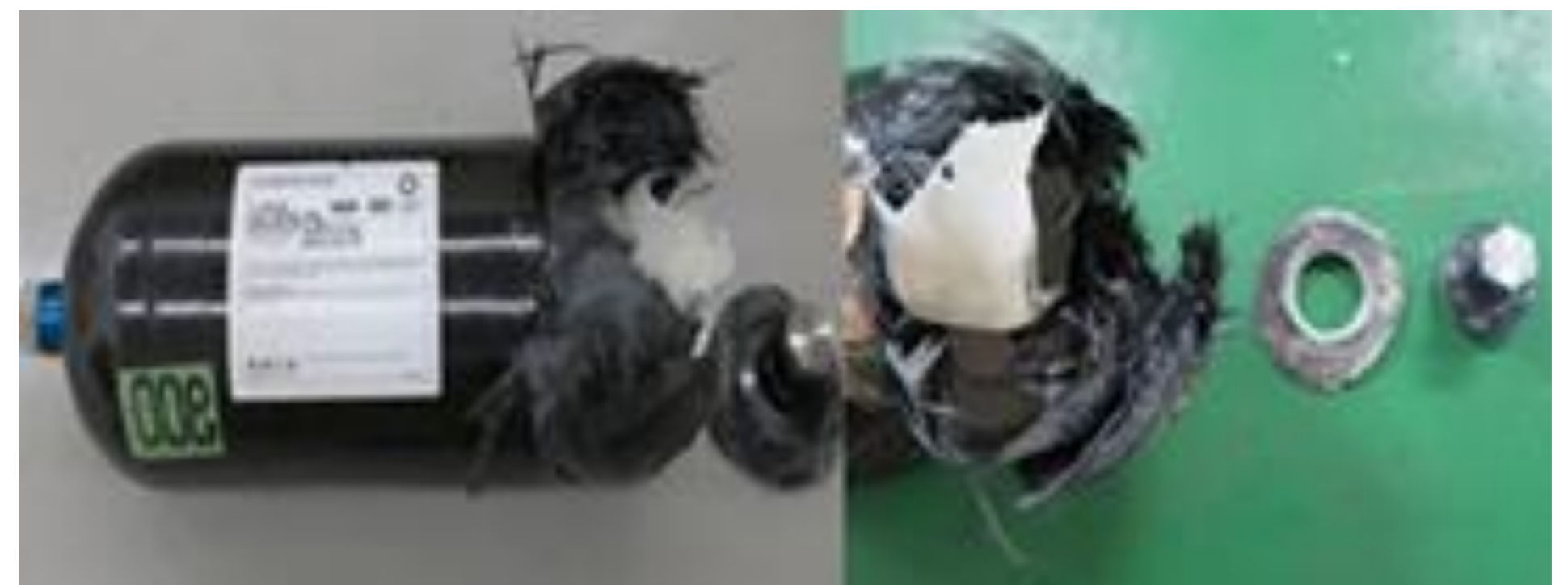
容器破裂試験によるシミュレーションの検証
