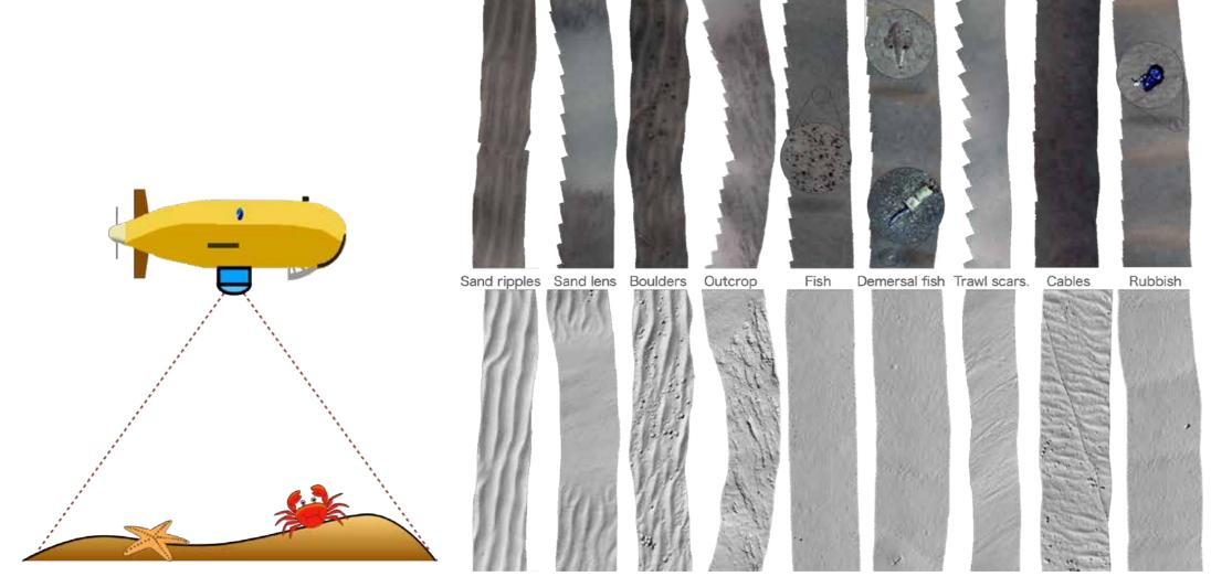
深海カメラやレーザを開発し、ロボットで海底 画像と微地形を広範囲で詳細にマッピング
