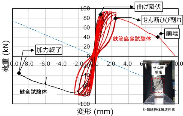
鉄筋腐食した試験体で崩壊変形が小さくなり、腐食の影響で変形能力が小さくなることを確認
