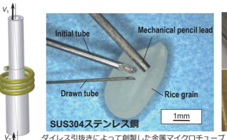
ダイレス引抜きによって創製した金属マイクロチューブ
