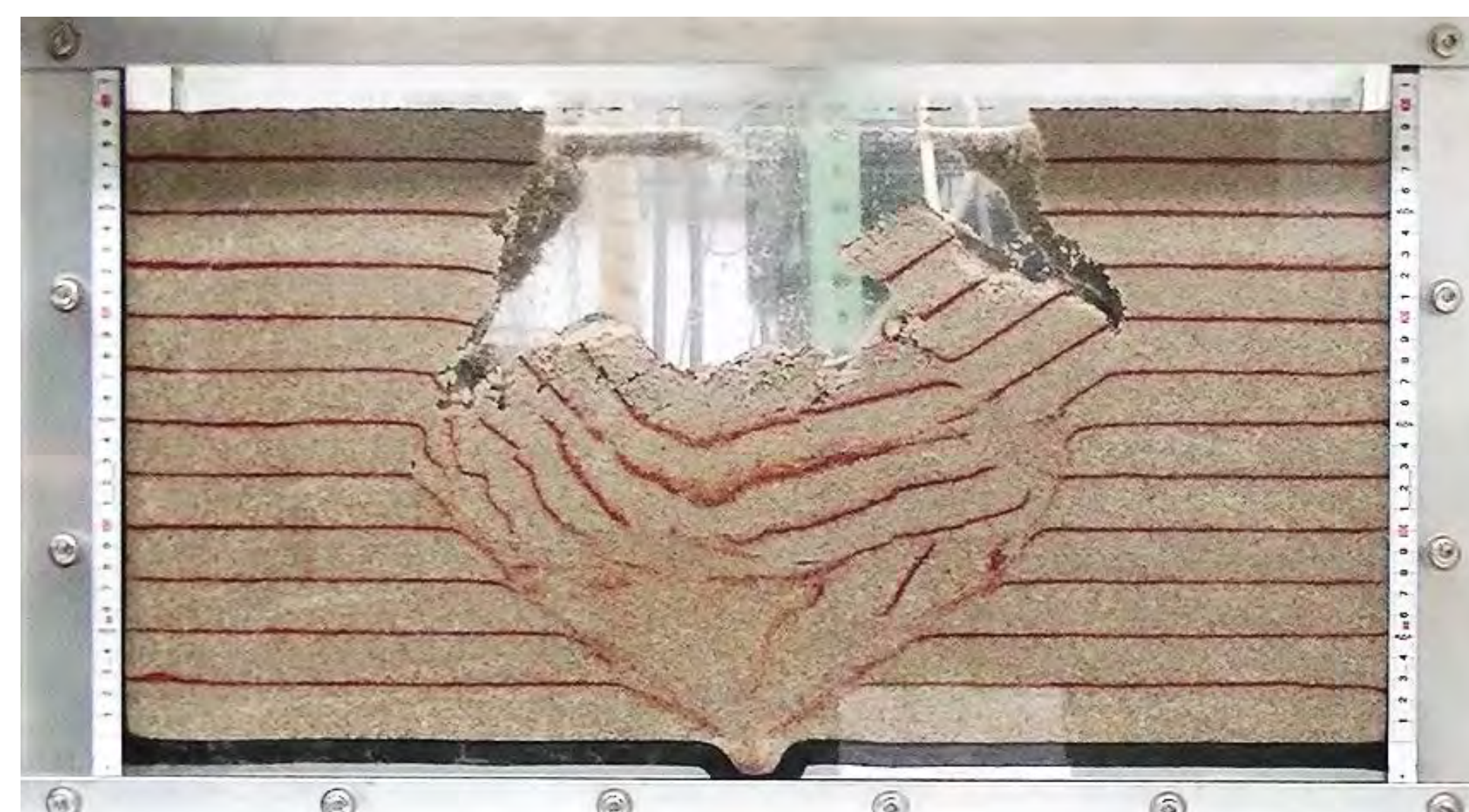
室内模型実験による博多駅前陥没事故（2016年11月）の土砂流出メカニズムの再現
