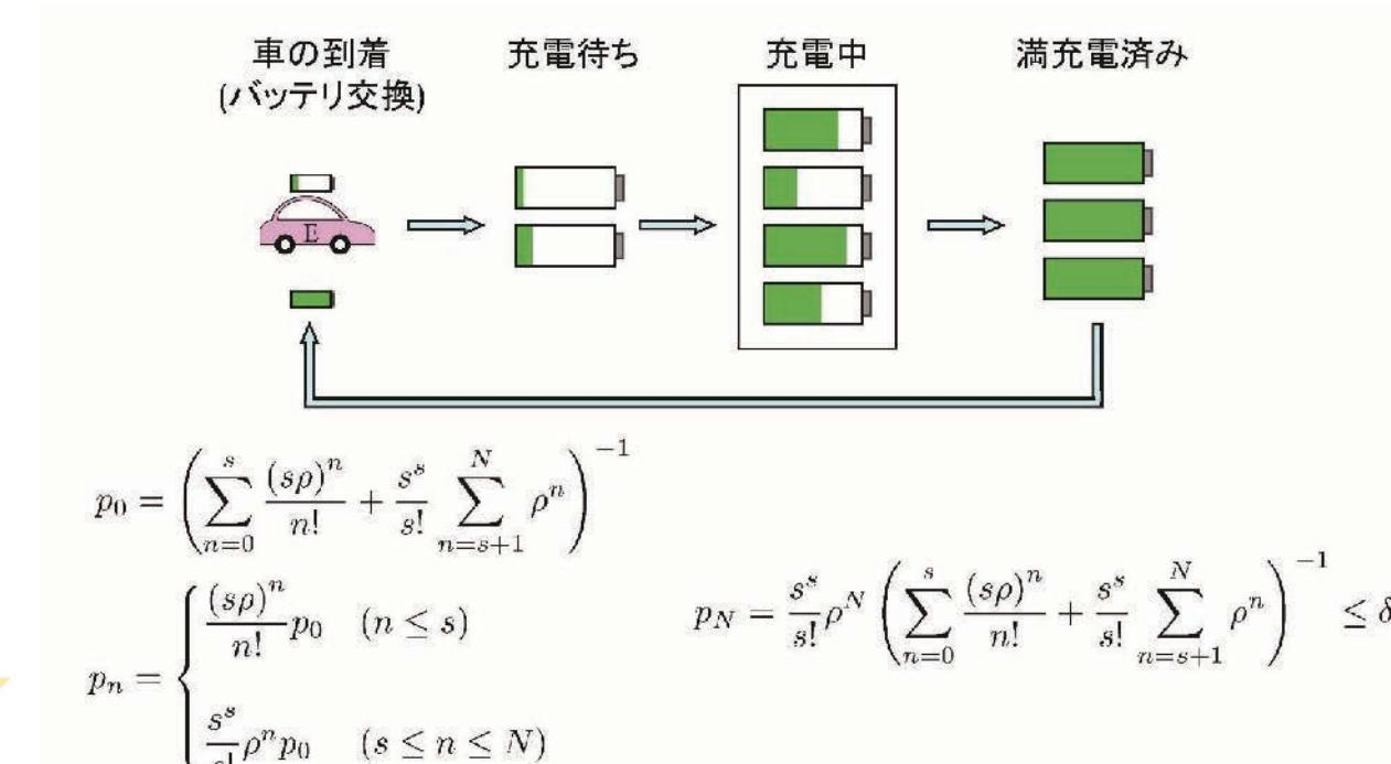
本研究では、電気自動車(EV)の支援インフラとして、バッテリー交換型ステーションを想定した上で、バッテリー在庫という観点から、その適切な運用形態を評価しています。
