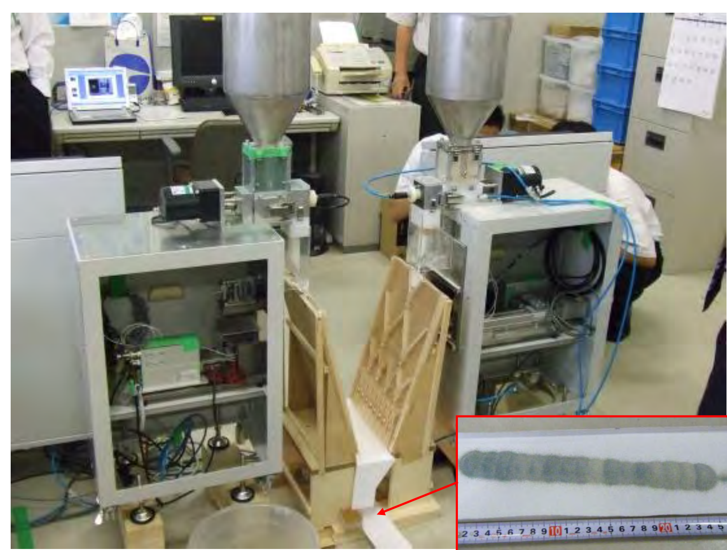
粉体の立体混合装置と、それを用いた Al 2 O 3 とSiCの混合物
