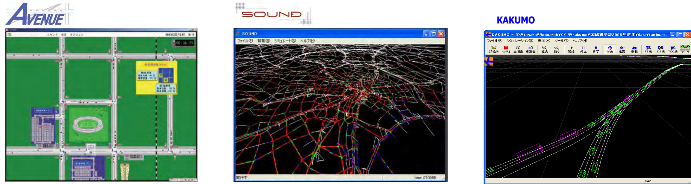
AVENUE 街路交通シミュレータ 渋滞緩和策評価などに使用 SOUND ネットワーク交通シミュレータ 数十km範囲の広域を対象 KAKUMO ミクロ交通シミュレータ TSとDSを接続
