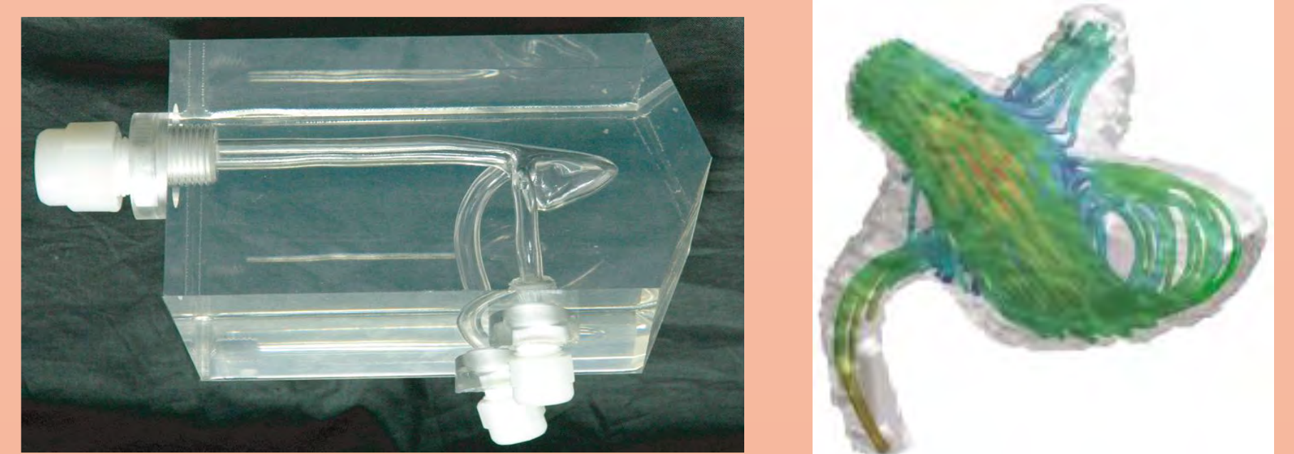
脳動脈瘤の実血管形状モデル 動脈瘤内の流線
