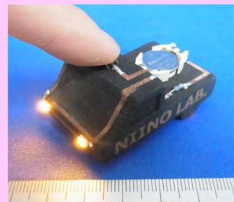
AMとMID (Molded Interconnect Device)の立体配線への適用
