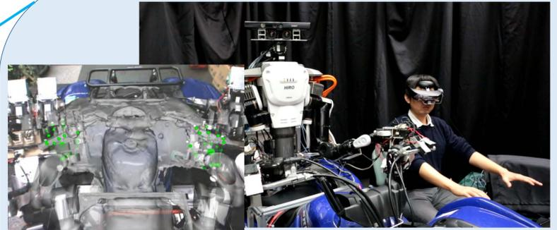
ヒューマノイドロボット遠隔教示システムの開発
