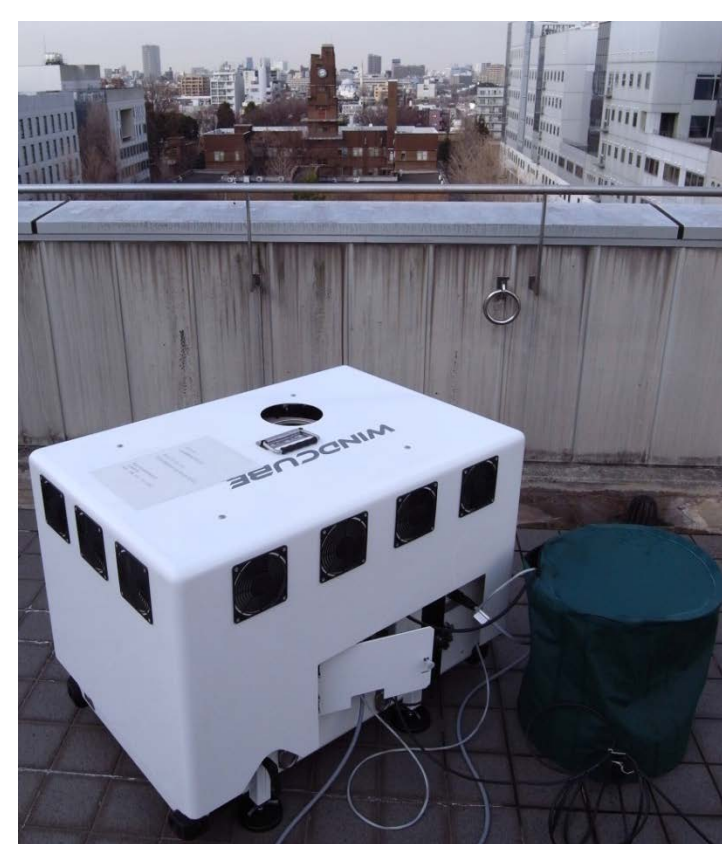
■ドップラーライダーを 用いた風速実測
