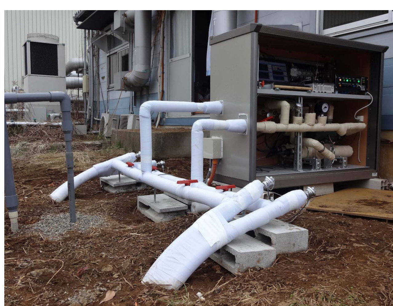
■地中の熱伝導率を同定するための 熱応答試験
