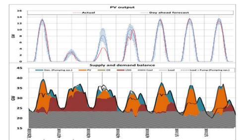
太陽光発電の予測、起動停止計画、経済負荷配分シミュレーションの例
