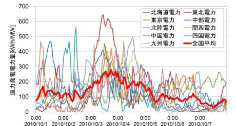
風力発電電力量の変動例
