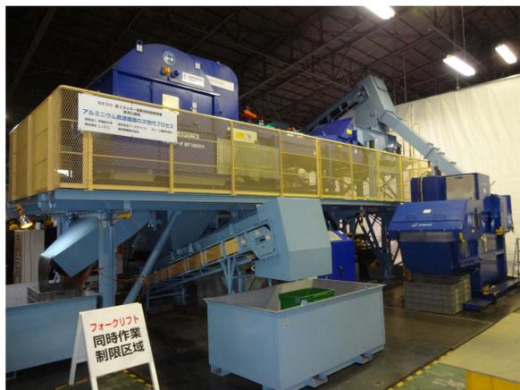
XRT・XRFソータを活用した「サッシtoサッシ」プラント
