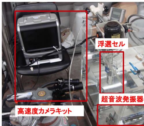
超音波照射マイクロバブル浮選装置(周波数によりバブルの凝集分散性を制御)
