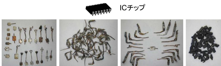
中心部の金属素材 足部分 部品内部の金属 プラスチック
