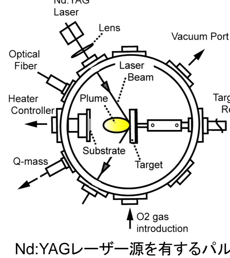
Nd:YAGレーザー源を有するパルスレーザー蒸着装置。意図しない不純物の混入を極力避けるため、 $10^{-7}$  Paの背圧を維持している。
