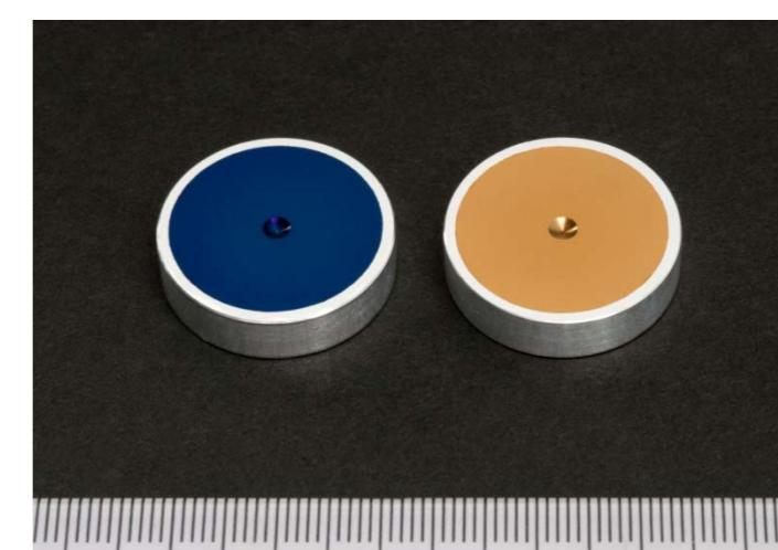
DLCがコーティングされたアルミ合金製機械摺動部品。色の違いは膜厚に依存した干渉により生じている。これはDLCが可視光領域で透明であることを示している。
