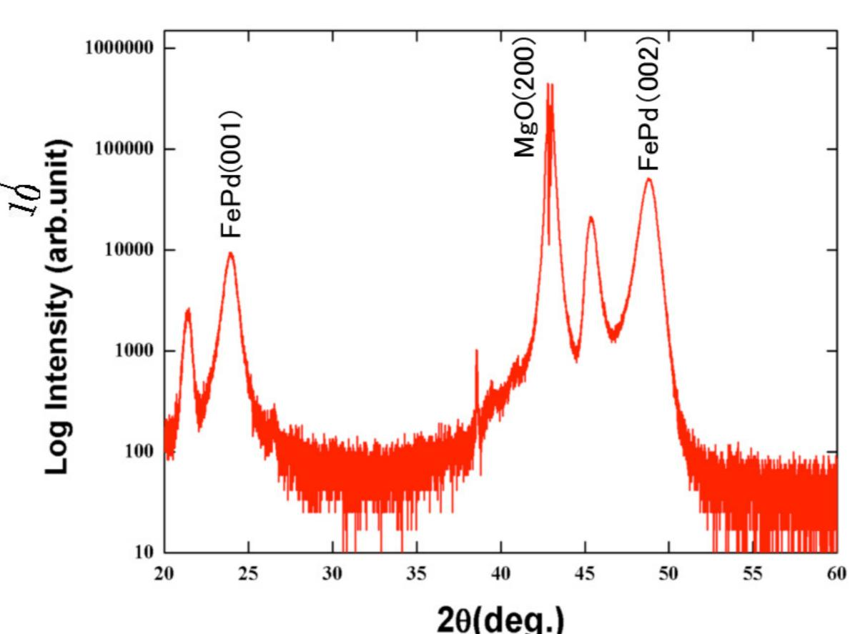
Feシード層およびAu凝集層の堆積により、単結晶MgO基板上に形成された数十nmのFePdナノドット薄膜。AFM像とXRDパターンから均質なナノドット構造と結晶配向性が確認できる。
