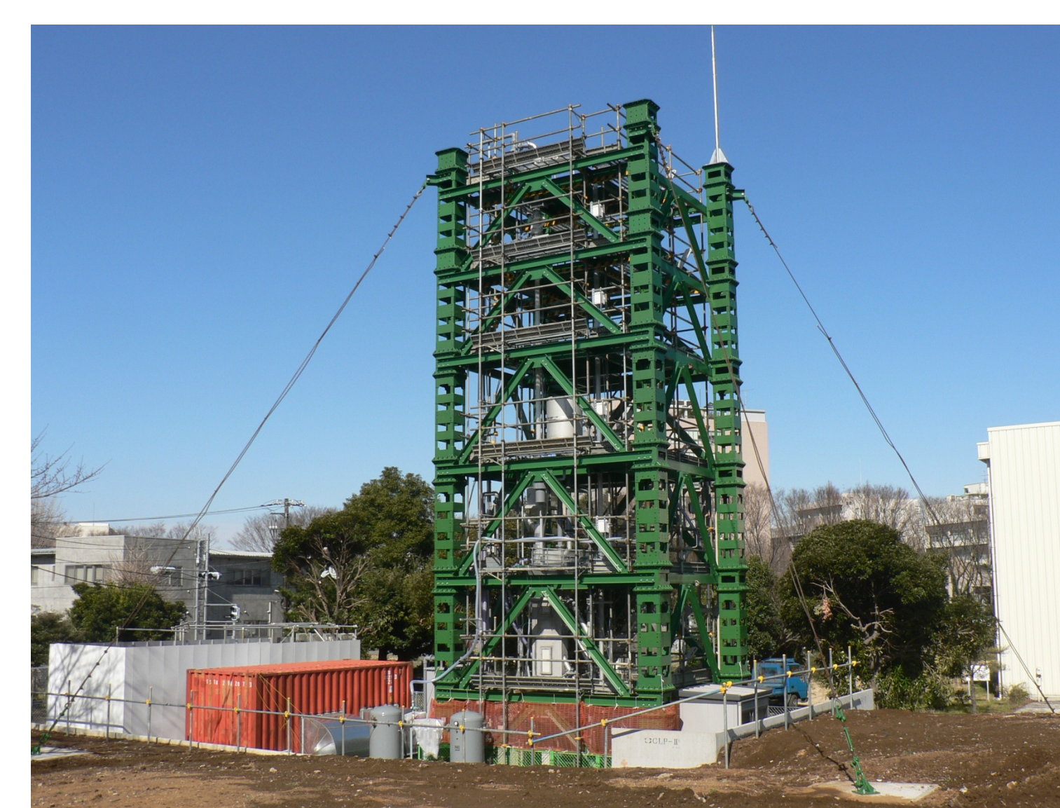
千葉実験所 大型循環流動層コールドモデル (高さ16 m, 直径0.10 m)
