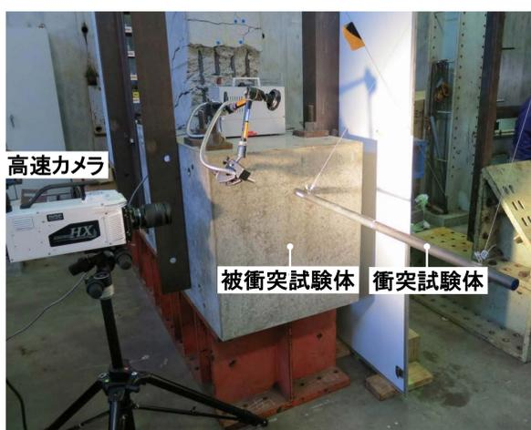
簡易振り子を用いた载荷実験の様子
