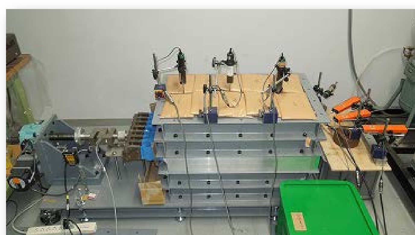
新しく開発したジオセルを用いた補強土擁壁の耐震性に関する研究 補強効果を引抜き試験と振動台模型実験で検討
