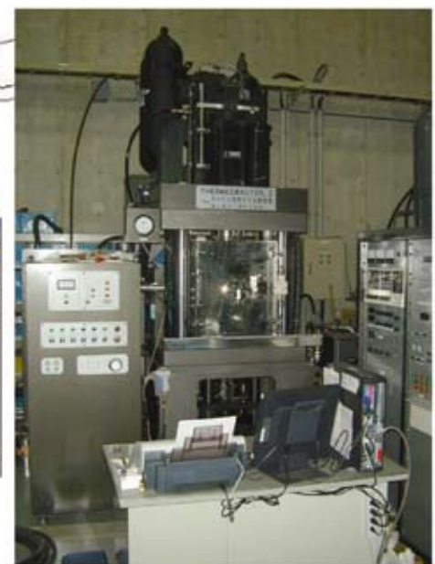
高ひずみ速度付与試験設備 High-speed compression testing machine
