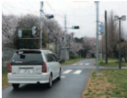
ITS実験用交通信号機と実験車（千葉実験所）
