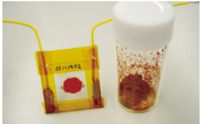
図2 右：有機ポリマーフォトリラクティブ材料。左：材料をITO電極つきガラス基板にサンドイッチしたデバイス。
