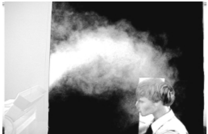
パーソナル空調機の吹出気流の可視化
