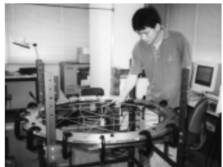
写真(3) 平板ラチス構造の波動伝播実験
