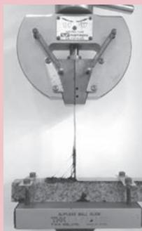
アスファルト試料の剥離試験
