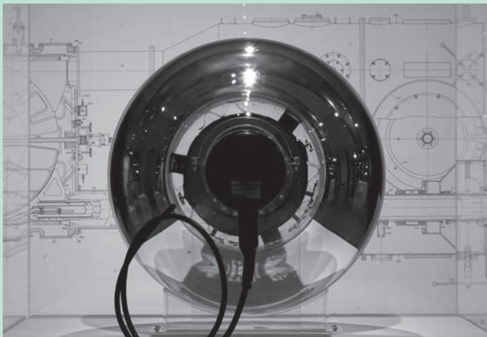
スーパーカミオカンデの光電子増倍管と大型サイクロトロン
