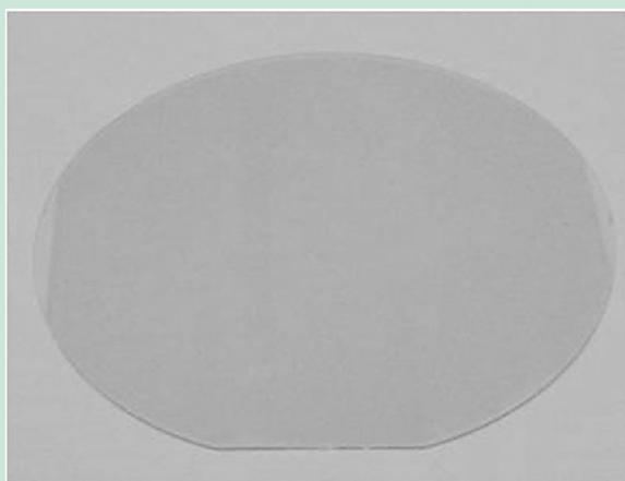
図1 φ 100mm 基板上的の IGZO 薄膜、膜厚 100nm
