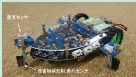
図2 アルコール放出源探索ロボット1号機
