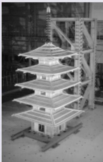
図1. 五重塔模型振動台実験
