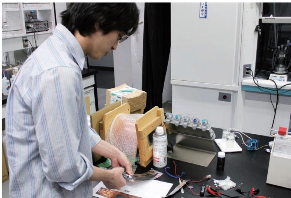
写真1: リチウムイオン電池を自作する修士1年生の田中宏樹君。まず正極活物質ペーストおよび負極活物質ペーストを、厚さ20 $\mu$ m程度のアリミニウム箔と銅箔にそれぞれ塗布します。これを十分に乾燥させて切り出した後、2032型コインセル(直径20mm、高さ3.2mmのコインセル)に組み込んで、電池特性を評価します。一から組み立てるので、着想したアイデアを即座に試すことができます。
