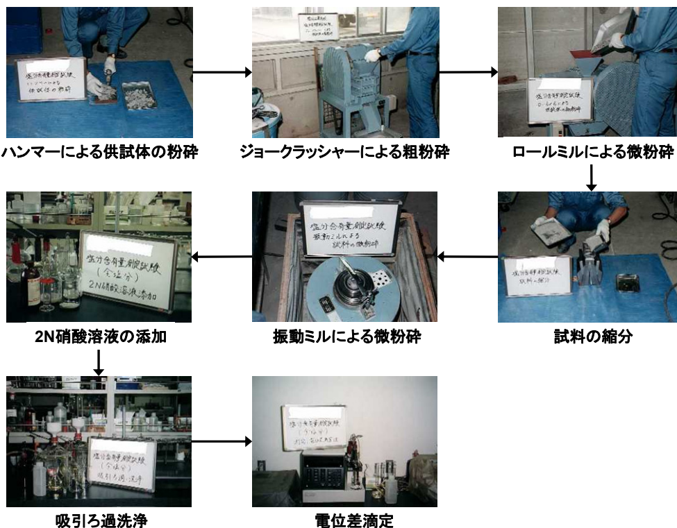
図-10 電位差滴定法によるコンクリート中の塩化物量の測定
