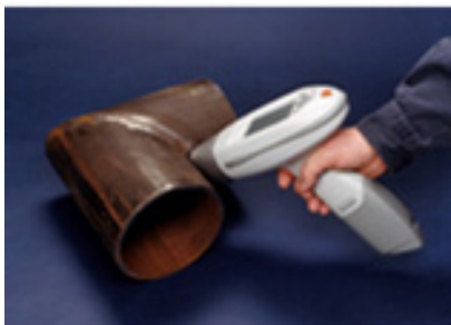
図-1 ハンドヘルド型蛍光 X 線分析装置
