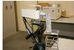
図-11 ポータブル型蛍光 X 線分析装置による塩害調査
