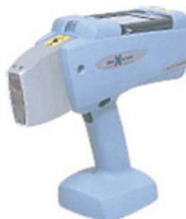
図-1 ハンドヘルド型蛍光 X 線分析装置
