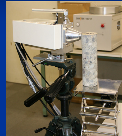
コンクリートコアの測定
