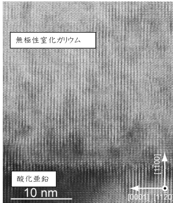
図1 酸化亜鉛上に結晶成長した次世代窒化ガリウムの電子顕微鏡写真； 原子間隔の近い酸化亜鉛上に規則正しく窒化ガリウム分子が並んでいることがわかる。
