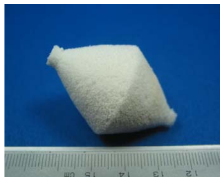
図 8 造形した足場
