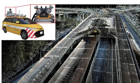
三次元測距レーザーを車載した
