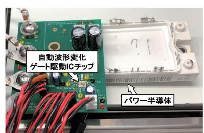
自動波形変化ゲート駆動 IC で
