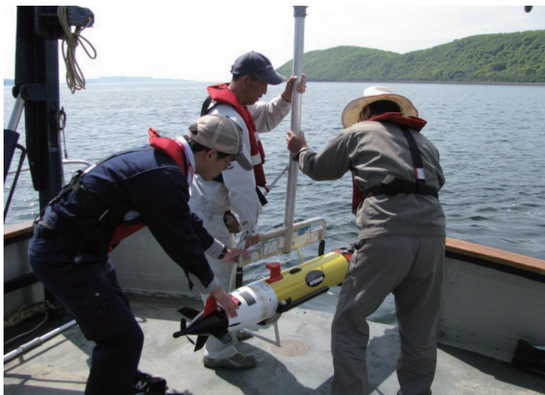
AUVと小型化学センサによる海洋計測（QICSプロジェクト、東京海洋大学）
