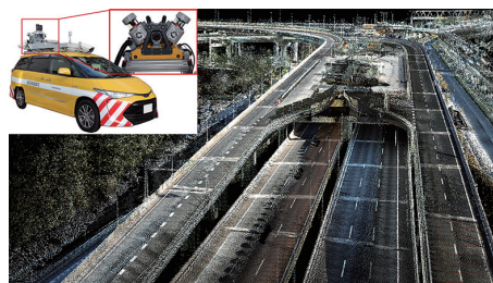
三次元測距レーザーを車載した モバイルマッピングシステム (MMS) によるインフラ形状のサイバー化技術 https://mizutanilab.iis.u-tokyo.ac.jp/
