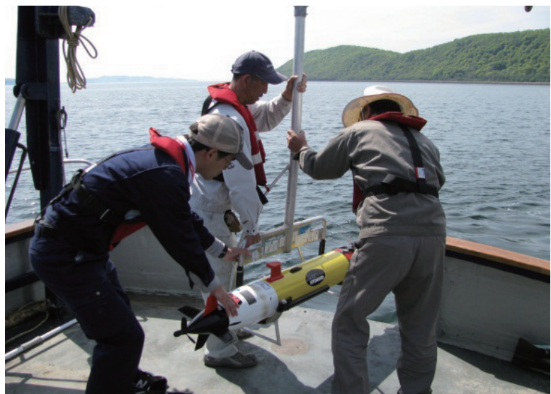
AUVと小型化学センサによる海洋計測（QICSプロジェクト、東京海洋大学）
