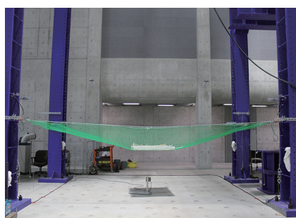
落下防止ネットへの天井板の落下実験
