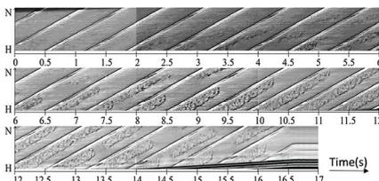
計量可塑化過程の可視化装置とガラス繊維強化PP(30wt%GF)の疑似展開積層画像
