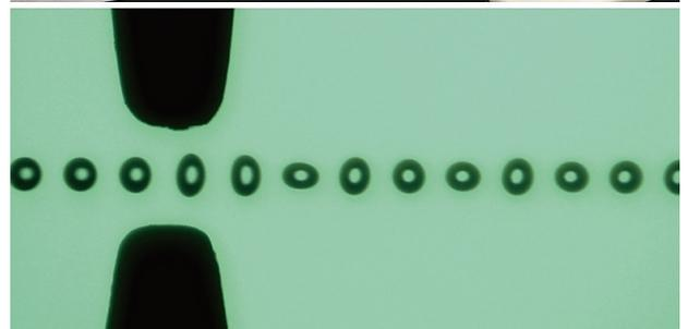
液体表面の状態変化を空中飛翔液滴の振動観察によって追跡！マイクロ秒の時間分解能を有する「表界面現象モニター装置」
