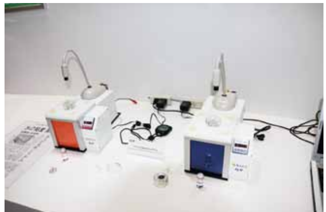
「低粘度液体の高精度測定を可能にする ディスク型EMS粘度計(レオキューブ)」
